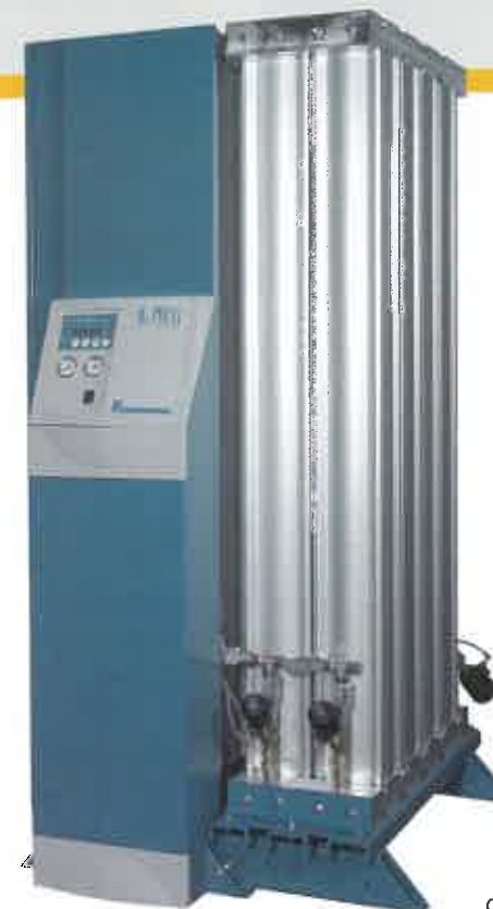
Generatore d'azoto Maxi, con portata di 130 m³/h. Come tutti i generatori d'azoto Claind, utilizza la tecnologia PSA (Pressure Swing Adsorption), per produrre un gas considerato "additivo alimentare E941"
